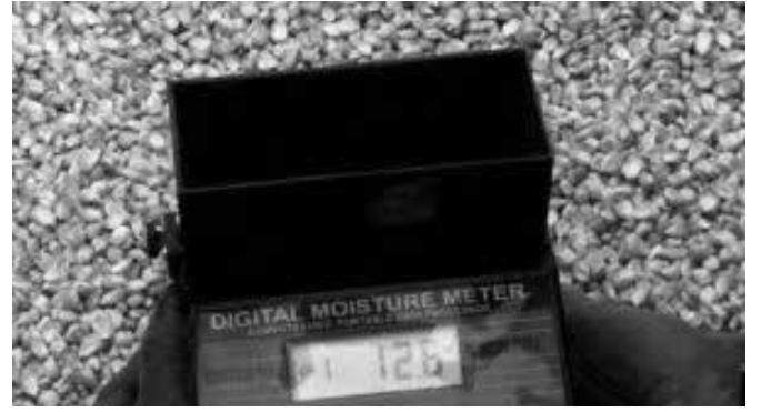
உற்பத்தியாளர் குழுக்கள் தங்களின் சோளத்தின் நல்ல தரத்தை அறிய உதவும் மின்னணு ஈரப்பத அளவிடும் கருவி
